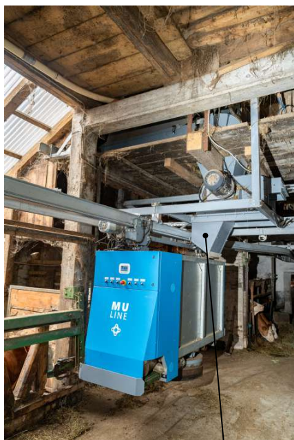
Lijak preko katerega se krma sipa iz zgornjega nadstropja v robota.
