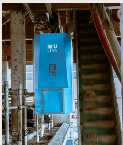
Verbindung zwischen Mischeranhänger und Förderrobotern
