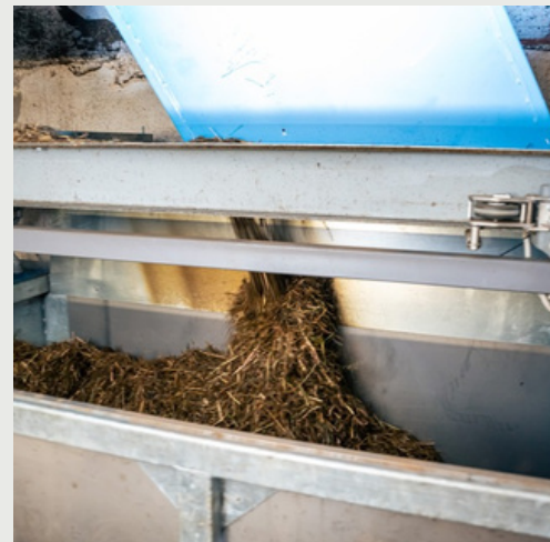
Futter aus dem oberen Stockwerk über den Trichter in den Roboter einfüllen.
