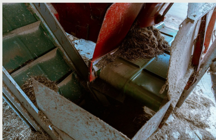
Verbindung zwischen Mischeranhänger und Förderrobotern
