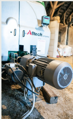
Elektromotor für den Antrieb eines Mischwagens
