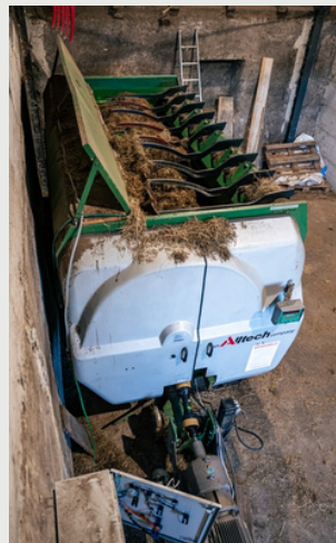
Elektromotor für den Antrieb eines Mischwagens
