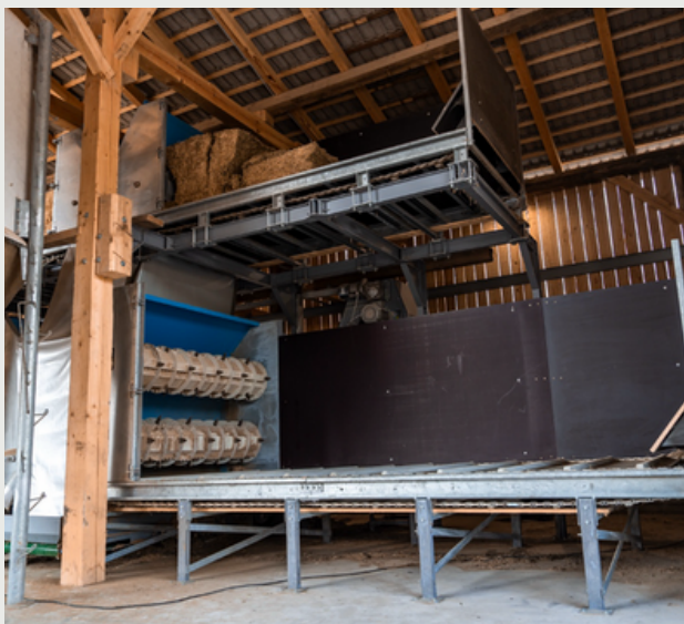
Dosiertisch für Silagewürfel oder -ballen
